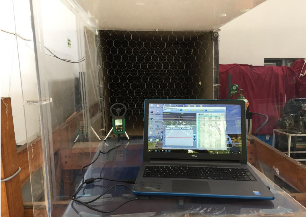
Figura 9: Caracterización de perfil de velocidad en el túnel de viento utilizado para las pruebas de medición.
