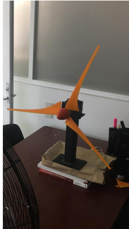
Figura 8: Fabricación de los componentes de la turbina eólica de 50 W mediante la técnica de impresión 3D, en material PLA
