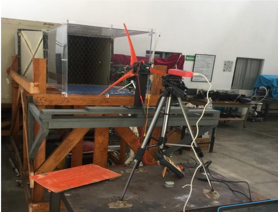
Figura 10: Equipos auxiliares usados en la medición de parámetros. Tacómetro en la parte posterior del rotor, voltímetro en la parte inferior del trípode y anemómetro en la salida del túnel de viento.
