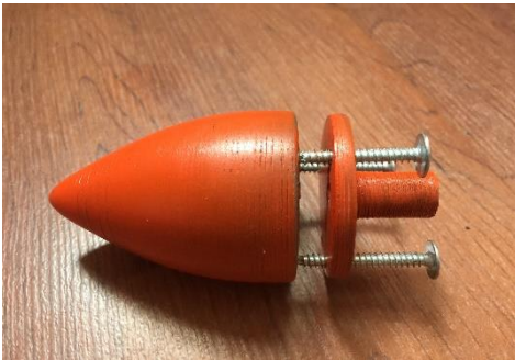
Figura 8: Fabricación de los componentes de la turbina eólica de 50 W mediante la técnica de impresión 3D, en material PLA
